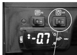
INTERRUPTOR DA ILUMINAÇÃO INTERNA
